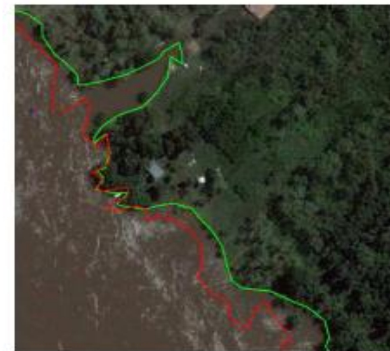
Figura 4 Erosión en el hueco 2 (entre X = 4000 m y X = 4500 m)-
